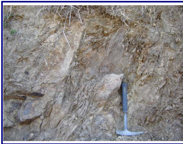
FIGURA 6. CALCILUTITAS FRACTURADAS Y METEORIZADAS
