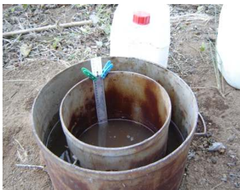
FIGURA 24 PRUEBA DE INFILTRACIÓN CON DOBLE ANILLO
