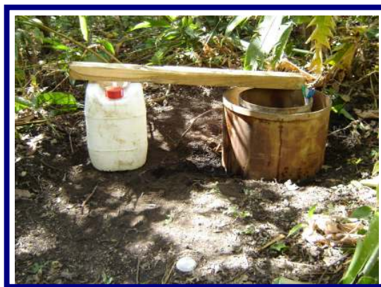
FIGURA 25 PRUEBA DE INFILTRACIÓN CON DOBLE ANILLO EN LA ZONA DE SANTA MARTA
